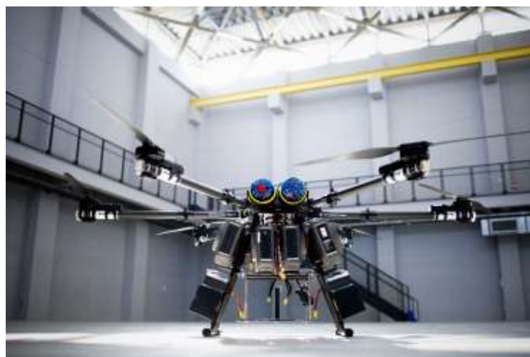
※水素燃料電池+LiPoバッテリーを搭載したHybridドローン機体
